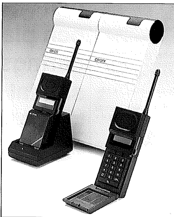
På bilden visas en av testtelefonerna med laddställ och basmodul
