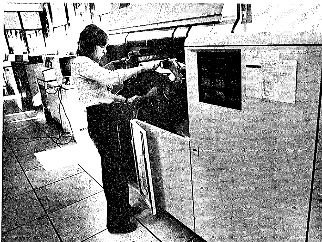
Printeroperatören Marita Martinsson, 2150, i färd med att finjustera pappersframmatningen på IBM 3800.
